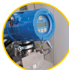
Cella di misurazione della forza di Coriolis
