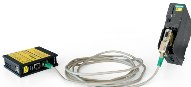
Anschluss an SPS mit MPI-Schnittstelle MPI-Ethernet-Adapter für LAN-Anschluss nötig
