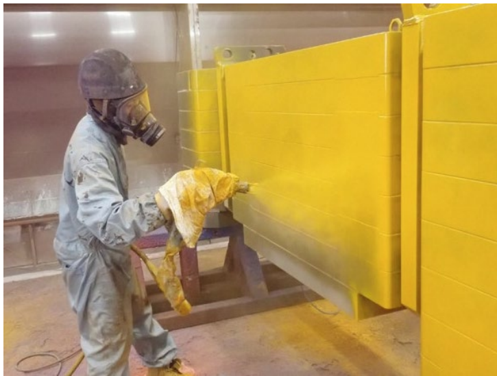
Elektrostatische Beschichtung von Krankkomponenten mit der Handpistole GM 5000EAC
