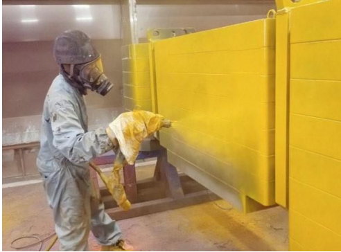
Verniciatura elettrostatica dei componenti delle gru con pistola manuale GM 5000EAC.
