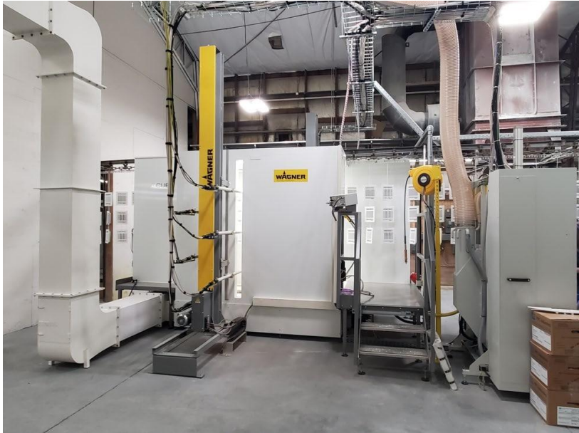
Nuovo sistema E-Line presso Shoemaker con cabina, centro polveri, ciclone e filtro
