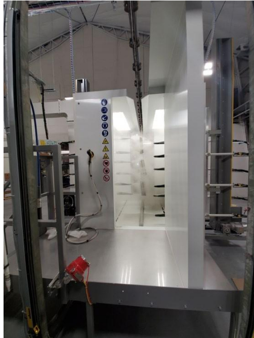
Rivestimento automatico di involucri metallici per bocchette d'aria e serpentine di riscaldamento
