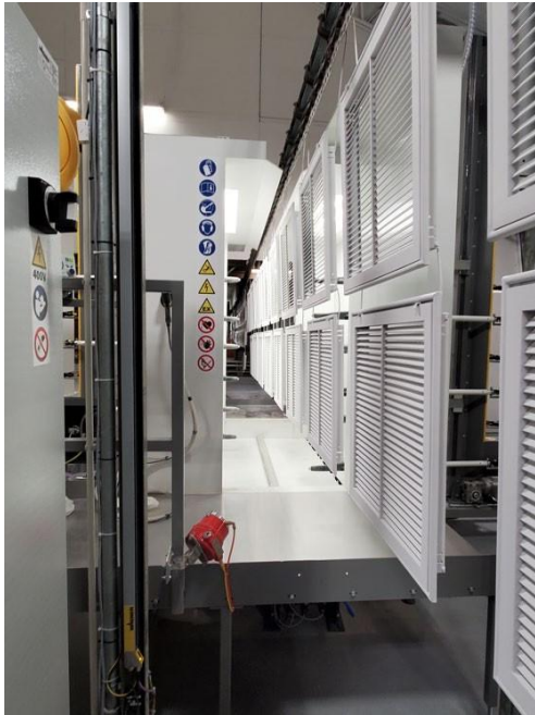
Rivestimento automatico di involucri metallici per bocchette d'aria e serpentine di riscaldamento
