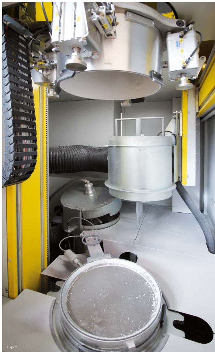
Il setaccio a ultrasuoni fa la differenza quando si applicano finiture metallizzate e testurizzate.
