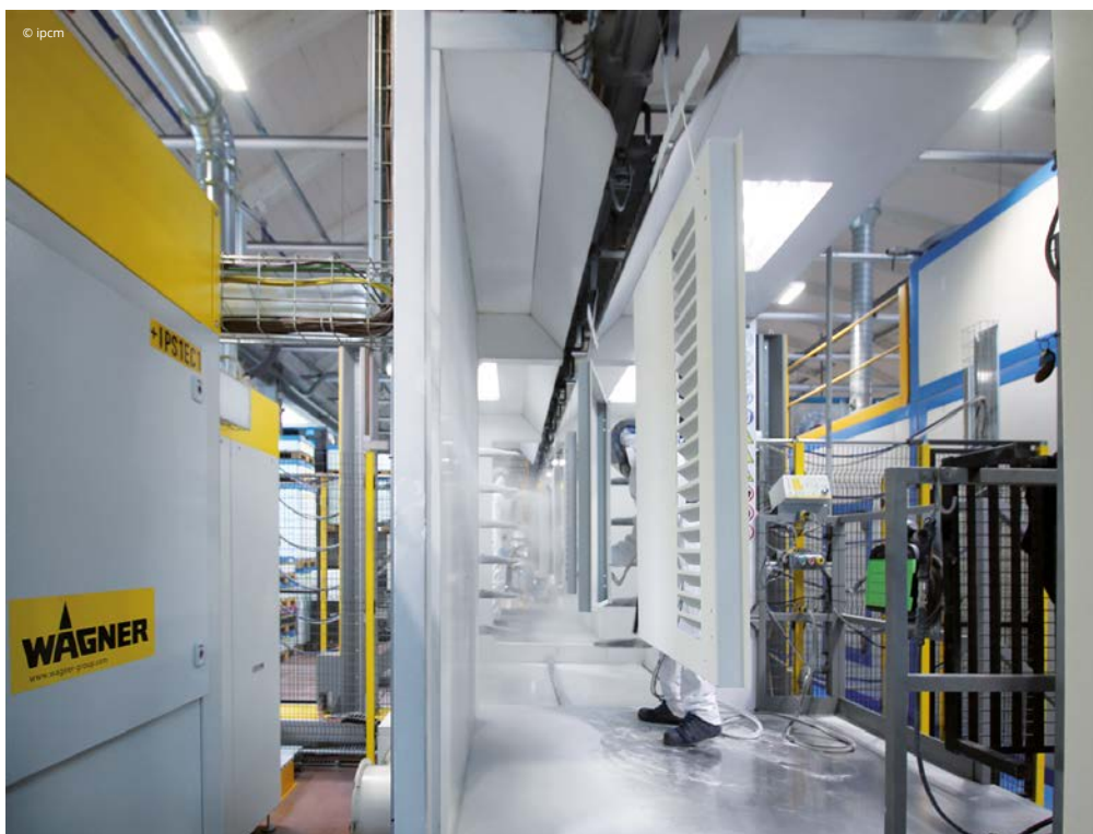
Combinato con una cabina autopulente, un sistema di recupero della polvere, pistole e altri componenti, IPS è il primo sistema a polvere completamente automatizzato mai configurato.
