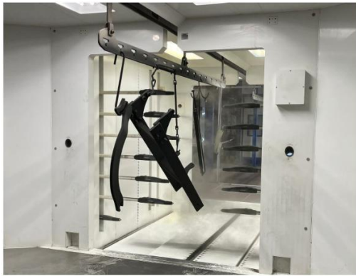
Verniciatura polvere 3D dei pezzi nella cabina S-cube.
