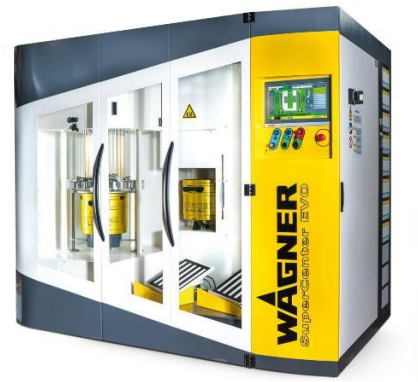
SuperCenter EVO per rapidi cambi colore con elevato grado di automazione.
