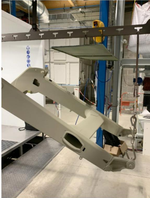
Componenti di machine agricole durante il processo di rivestimento.
