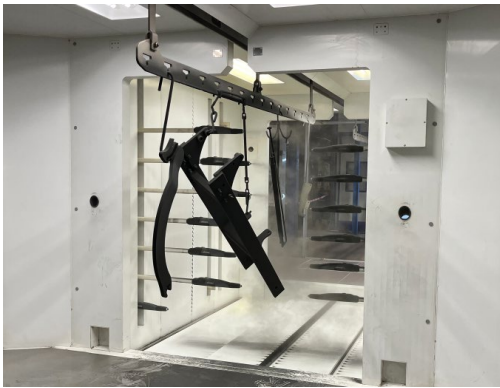
Peinture en poudre en 3D de pièces dans la cabine couleur S-Cube
