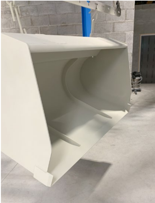
Composants de machines agricoles pendant le processus de peinture
