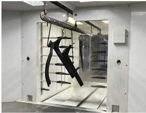
Recubrimiento en polvo 3D de piezas en la cabina de color S-Cube
