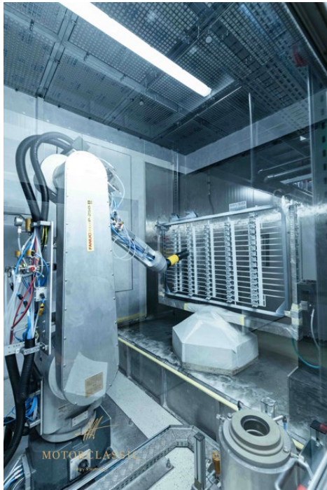
Der Hochrotationszerstäuber TOPFINISH RobotBell 1 trägt den Klarlack auf
