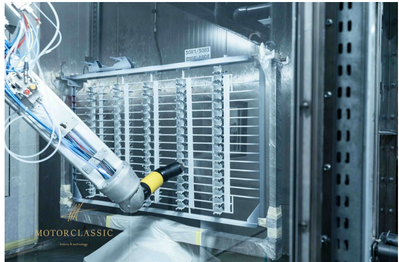
Der Hochrotationszerstäuber TOPFINISH RobotBell 1 trägt den Klarlack auf
