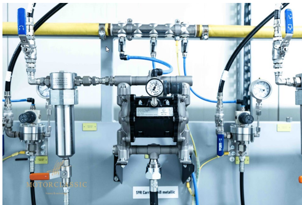
Farbversorgung mit ZIP 52 Doppelmembranpumpen und verschiedenen Fassdeckelhebstationen
