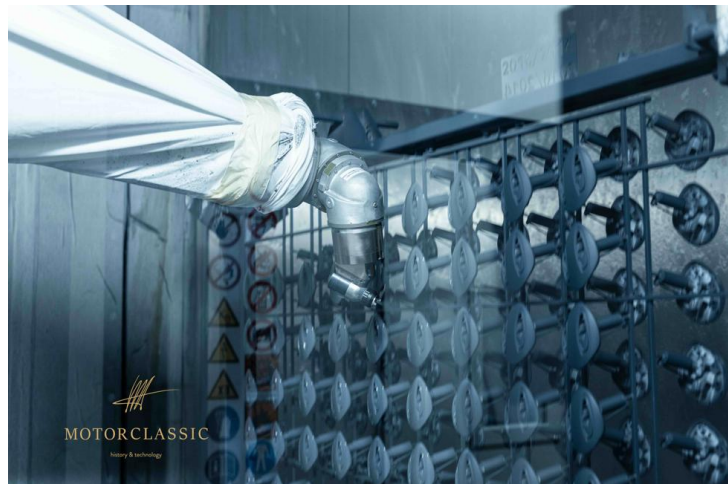
Pistola GA 1900 per l'applicazione di componenti con nebulizzazione estremamente fine
