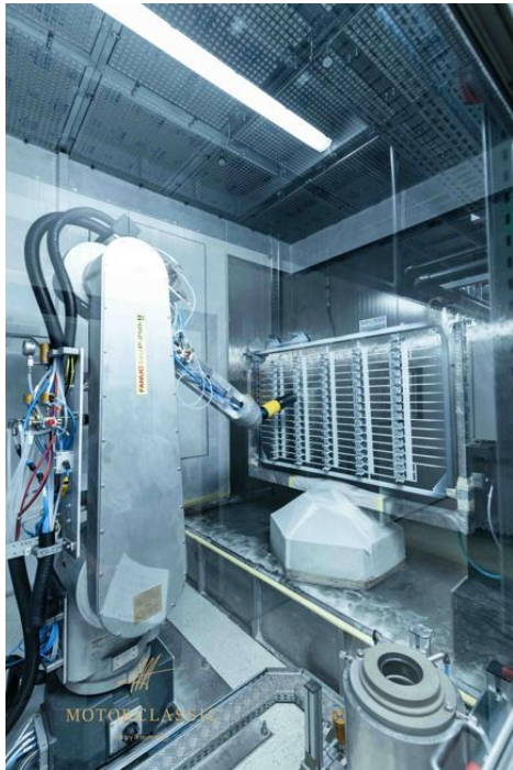
La TOPFINISH RobotBell 1 applica la vernice trasparente.
