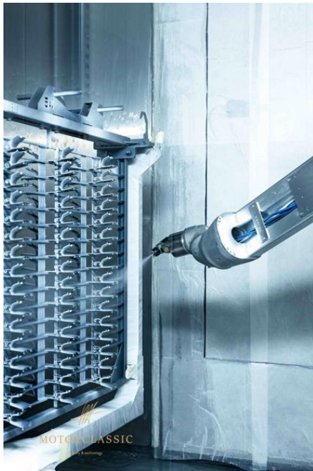
Pistola GA 1900 per l'applicazione di componenti con nebulizzazione estremamente fine
