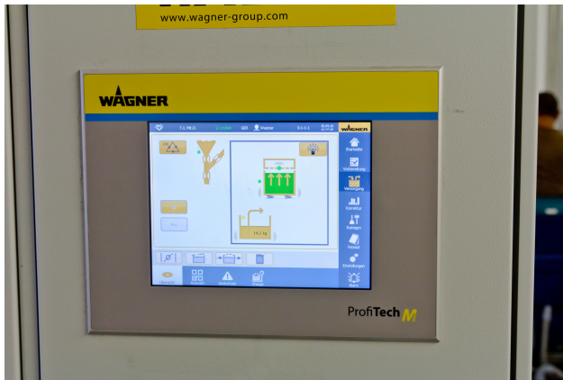
Bild: Benutzerfreundliche Touchscreen-Menüs unterstützen die Effizienz der Pulverbeschichtungsanlage
