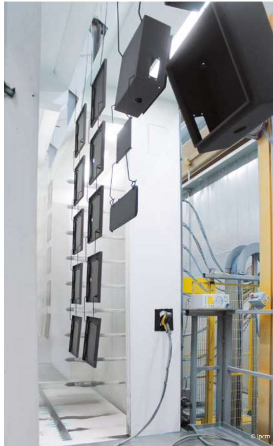
Applicazione della tinta monocolora nella cabina installata da Wagner nel 2008 (a sinistra) e la cabina per l'applicazione delle tinte di diverso colore.
