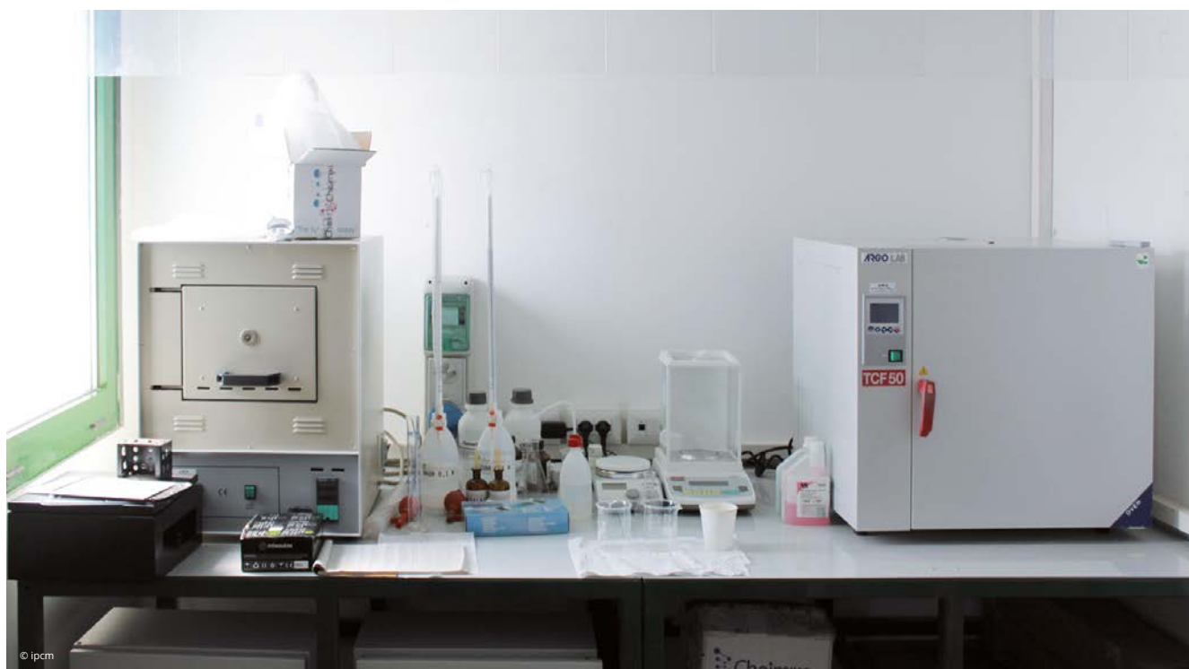
I dispositivi per il controllo dei parametri del pH dei bagni di pretrattamento e della vernice cataforetica.
