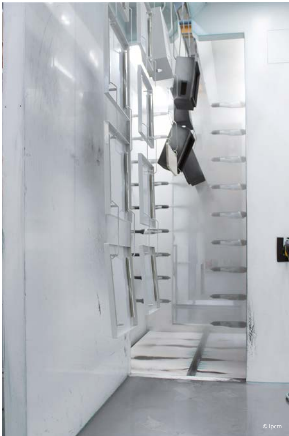
Applicazione della tinta monocolora nella cabina installata da Wagner nel 2008 (a sinistra) e la cabina per l'applicazione delle tinte di diverso colore.
