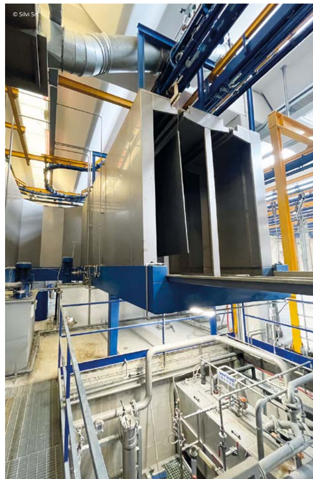
La vasca di cataforesi e il tunnel di lavaggio UF in acciaio inox 316 a doppio passaggio.
