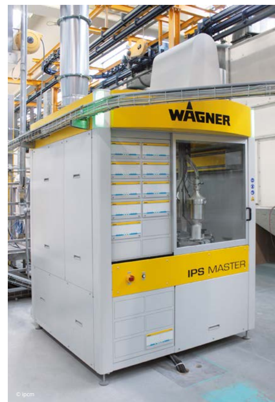
Il sistema IPS che gestisce la cabina multicolore: lo smart boxer può contenere due scatole e switchare automaticamente dall’una all’altra per una fornitura di polvere continua. A destra, il modulo IPS per la gestione delle polveri multicolore.
