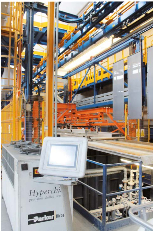
Il PLC di controllo del processo di cataforesi interconnesso con il gestionale aziendale e il forno di asciugatura di Tecnofirma SpA.
