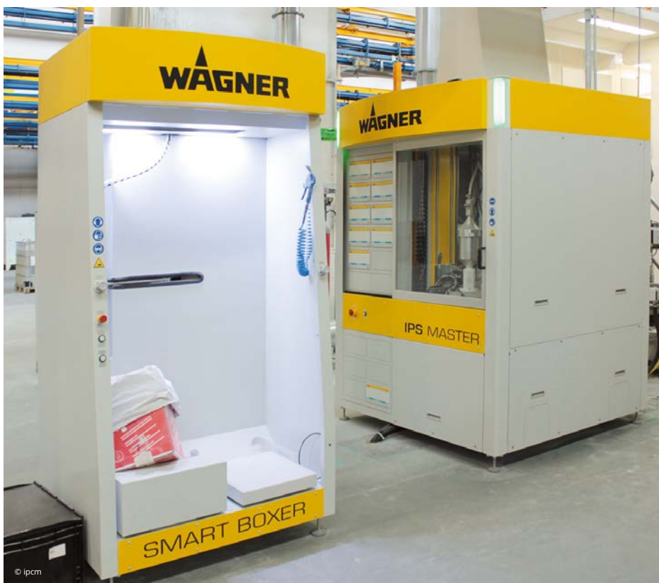
Il sistema IPS che gestisce la cabina multicolore: lo smart boxer può contenere due scatole e switchare automaticamente dall’una all’altra per una fornitura di polvere continua. A destra, il modulo IPS per la gestione delle polveri multicolore.
