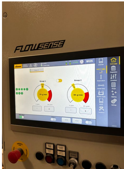
PXS Pulverzentrum mit Flowsense-Technologie zur digitalen Messung des Pulverausstoßes
