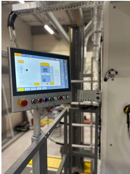
WICOS Steuerungssystem für das Monitoring des Beschichtungsprozesses
