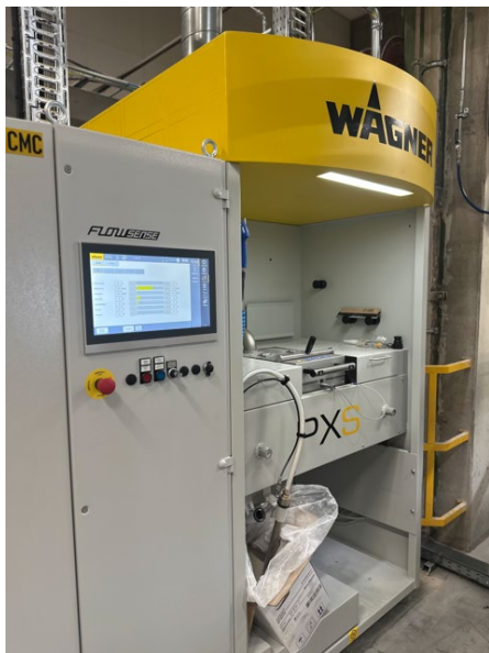
PXS Pulverzentrum mit Flowsense-Technologie zur digitalen Messung des Pulverausstoßes
