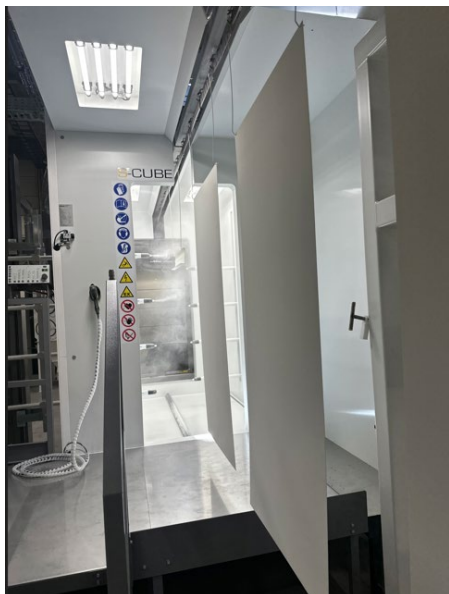
Pulverbeschichtung großer Aufzugskomponenten
