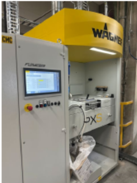
Centro polveri PXS con tecnologia Flowsense per la misurazione digitale della polvere in uscita
