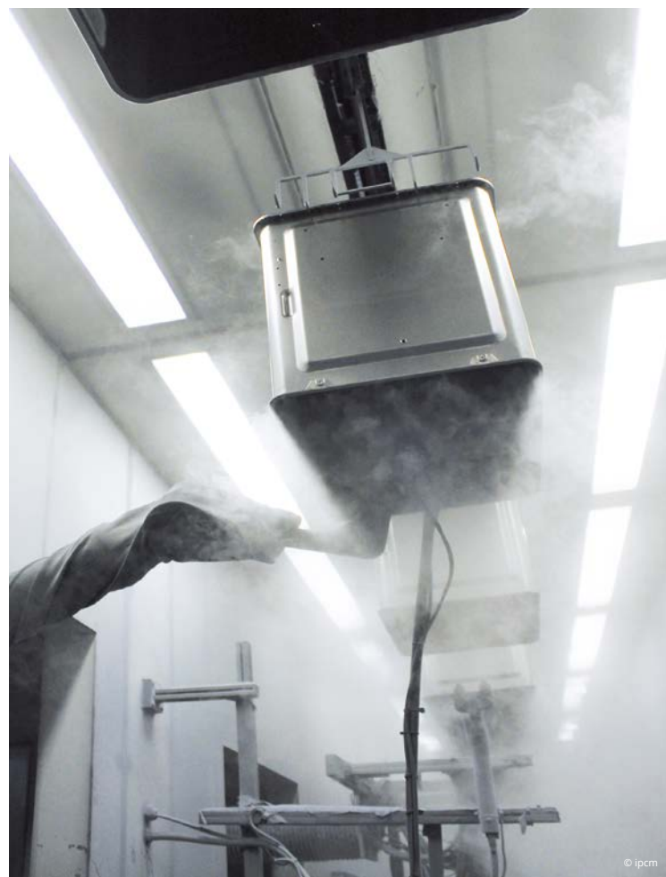
In primo piano, il robot a 6 assi vernicia "il cielo" della cavità del forno.
