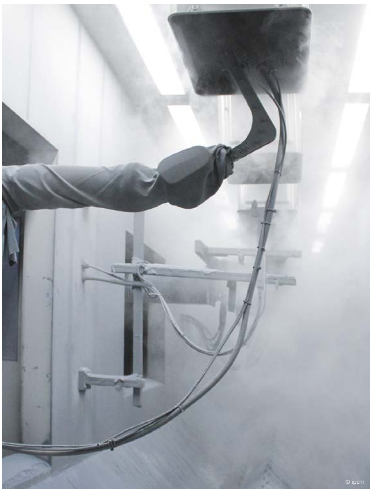
Interno della cabina di smaltatura Wagner delle cavità.
