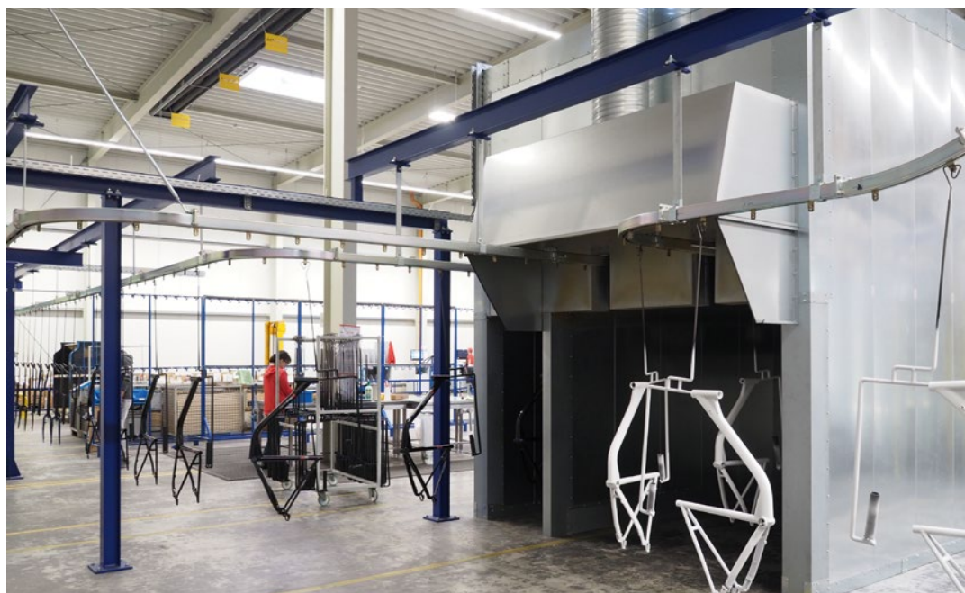
Nach Auftrag des Farblacks und Durchlauf durch Ofen und Abkühlzone (rechts) erhalten die Rahmen ihre Dekore (Mitte) und durchlaufen für die Applikation des Klarlacks den Prozess ein zweites Mal. Foto: Redaktion
