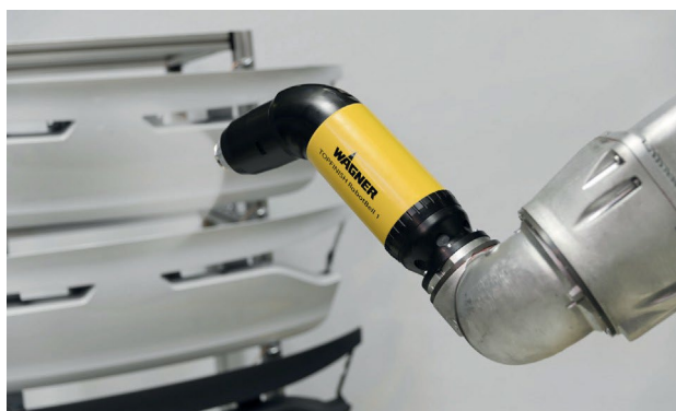
ロボットアームに搭載された高速回転霧化アトマイザー
