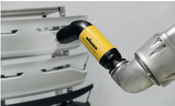
Hochrotationszerstäuber auf einem Roboterarm montiert
