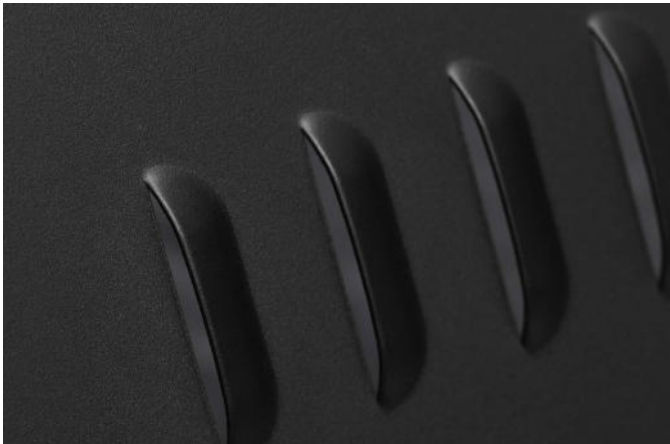
Nahaufnahme eines beispielhaften Metallwerkstücks von Fox Laser nach der Pulverbeschichtung
