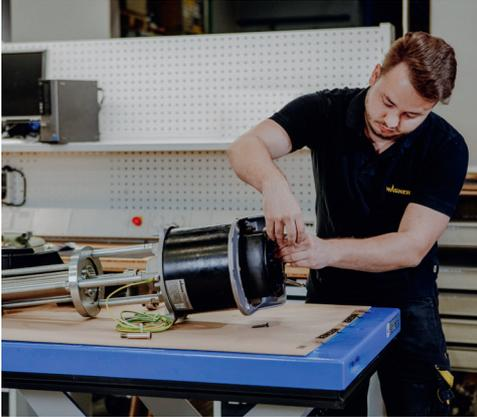
Die Reparatur kleinerer Komponenten für die Nasslack- und Pulverbeschichtung findet in der Reparaturwerkstatt am Standort Markdorf statt. Typische prüfpflichtige Baugruppen und Komponenten, die Sie zu einer Reparatur einsenden können, sind u.a. Hand- und Automatikpistolen, Pumpen, Handanlagen oder kleine Steuergeräte.
