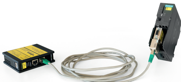
Connexion à l'automate programmable avec interface MPI Adaptateur MPI-Ethernet requis pour la connexion au réseau local
