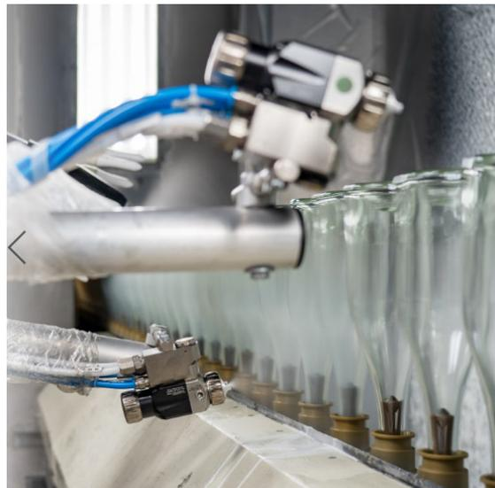
In der neuen Nasslackanlage werden in einem ersten Schritt die Glasflaschen mit den automatischen Airspray Pistolen GA 1030 bearbeitet.
