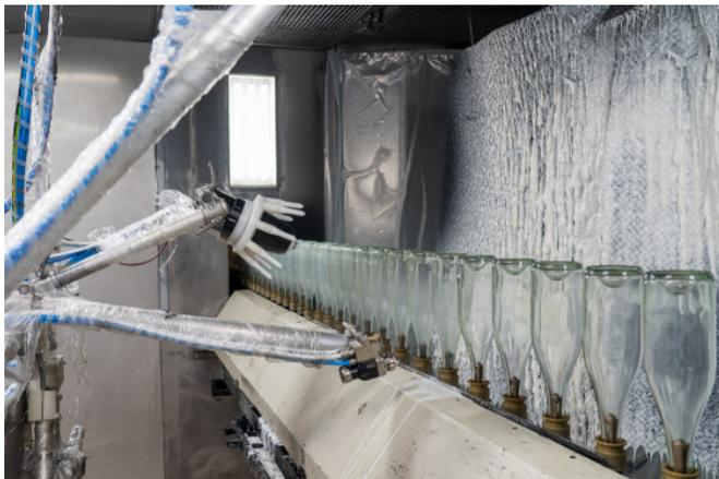
Elektrostatische Beschichtung mit Außenaufladung mit der TOPFINISH Bell 1S ECH.
