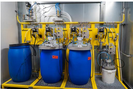
Mehrere Zip 52 Doppelmembranpumpen sorgen für eine zuverlässige Farbversorgung aus den Lackbehältern.
