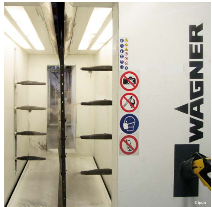
La cabina di applicazione automatica della polvere di Wagner.
