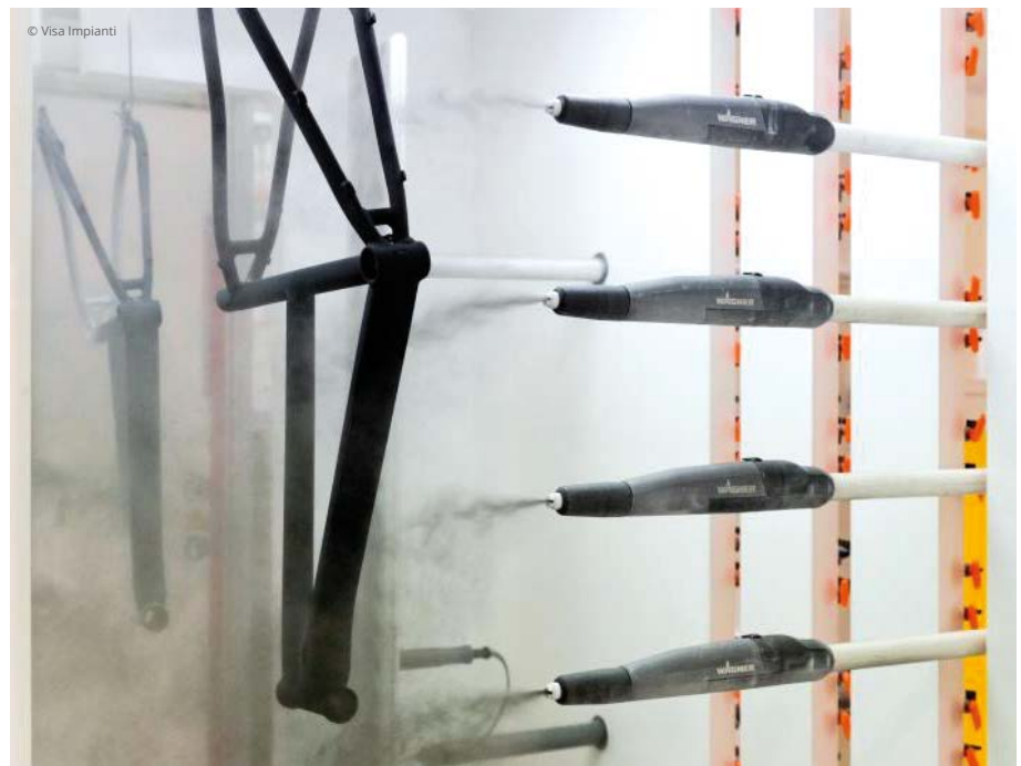
L’applicazione dei prodotti in polvere all’interno della cabina.
