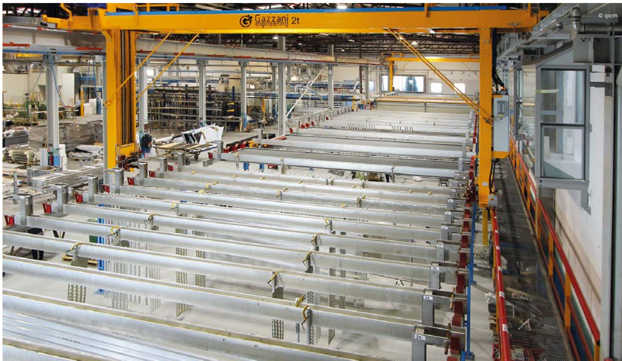
Buffer di accumulo nel reparto di ossidazione anodica e di pretrattamento alla verniciatura.
