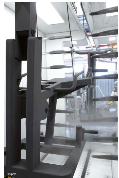
Con Smart Feeding Technology l'alimentazione della polvere avviene grazie all'utilizzo di un contenitore in pressione e di una valvola di dosaggio a controllo elettronico, e produce una nuvola morbida con poco overspray.
