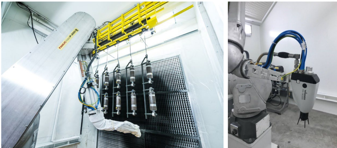
Primerizzazione nella cabina automatica con la pistola elettrostatica AirCoat GA 5000 EAC
