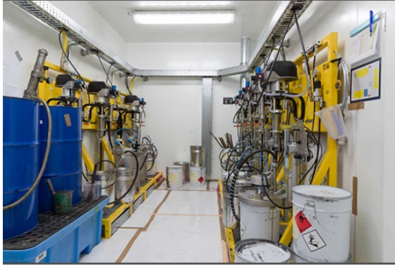
Alimentation en peinture avec les pompes à piston haute pression WAGNER
