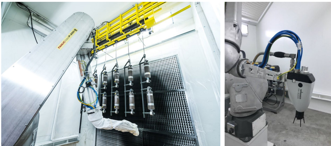
Application de l'apprêt dans la cabine automatique avec le pistolet électrostatique AirCoat GA 5000 EAC
