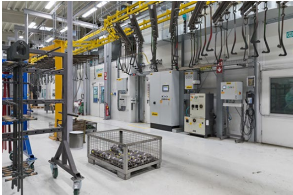
Alimentation en peinture avec les pompes à piston haute pression WAGNER
