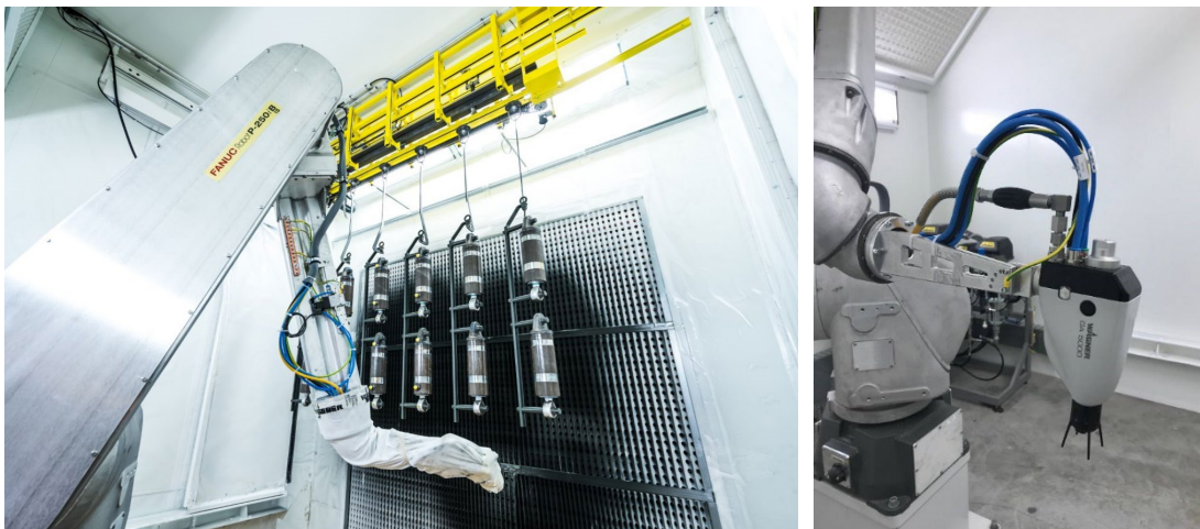
Imprimación en la cabina automática con la pistola electrostática AirCoat GA 5000 EAC
