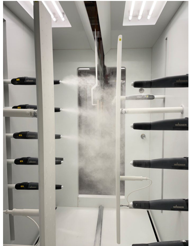
Verniciatura a polvere di parti non metalliche in cabina M-Cube con l'aiuto di sensori di campo
