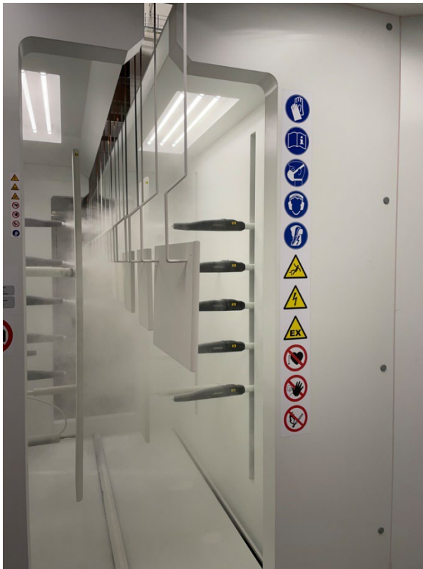
Verniciatura a polvere di parti non metalliche in cabina M-Cube con l'aiuto di sensori di campo
