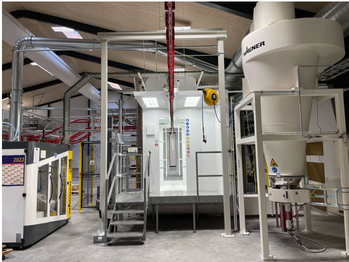
Système de poudrage M-Line avec centre de poudre SuperCenter EVO et monocyclone
