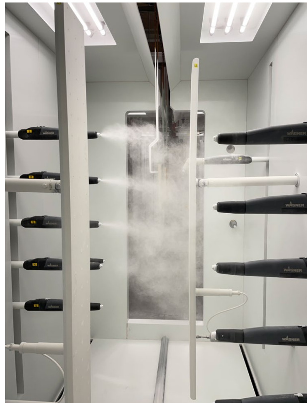
Recubrimiento en polvo de piezas no metálicas en el M-Cube con ayuda de controladores de campo
