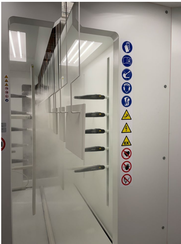
Recubrimiento en polvo de piezas no metálicas en el M-Cube con ayuda de controladores de campo
