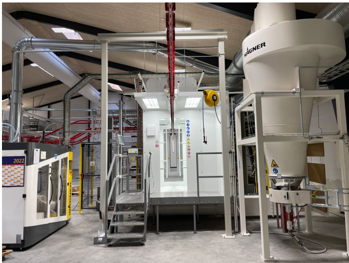
Sistema de polvo M-Line con central de polvo SuperCenter EVO y monocición
