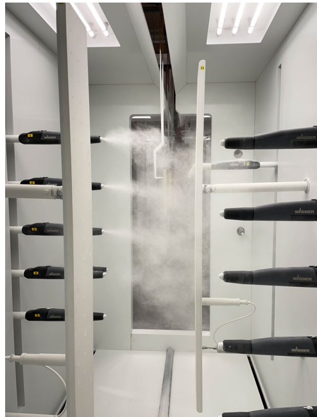
Pulverbeschichtung nicht-metallischer Werkstücke in der M-Cube Kabine mit Unterstützung der Feldcontroller
