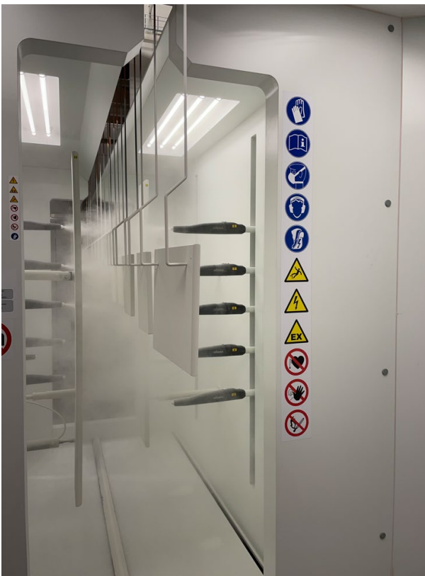
Pulverbeschichtung nicht-metallischer Werkstücke in der M-Cube Kabine mit Unterstützung der Feldcontroller
