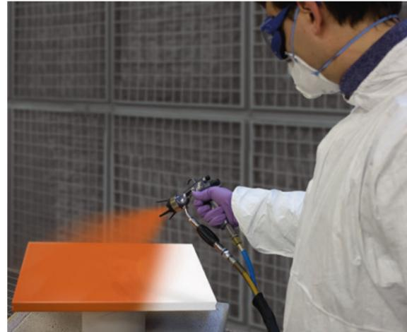
fache und präzise Einstellung der Zerstäuberluft und Sprühstrahlbreite für maximale Anwendungsvielfalt und Oberflächenqualität.
