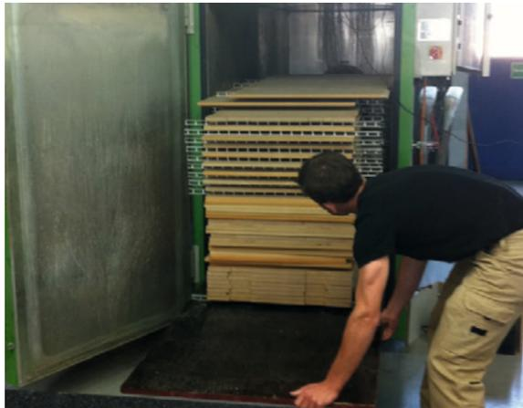
Zwangskonditionierung von MDF-Platten in einem Konditionierungsraum auf einen Feuchtgehalt von 4,5 % bis 6,5 % für 8 Stunden.
