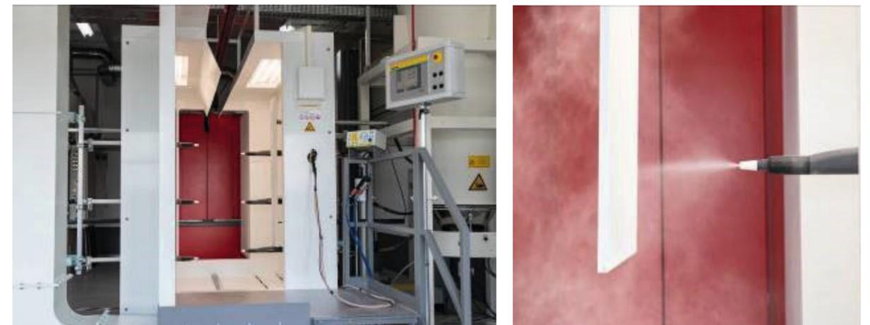
Moderne Pulverbeschichtungsanlage zur Holzbeschichtung (Quelle: Karl Bubenhofer AG)
