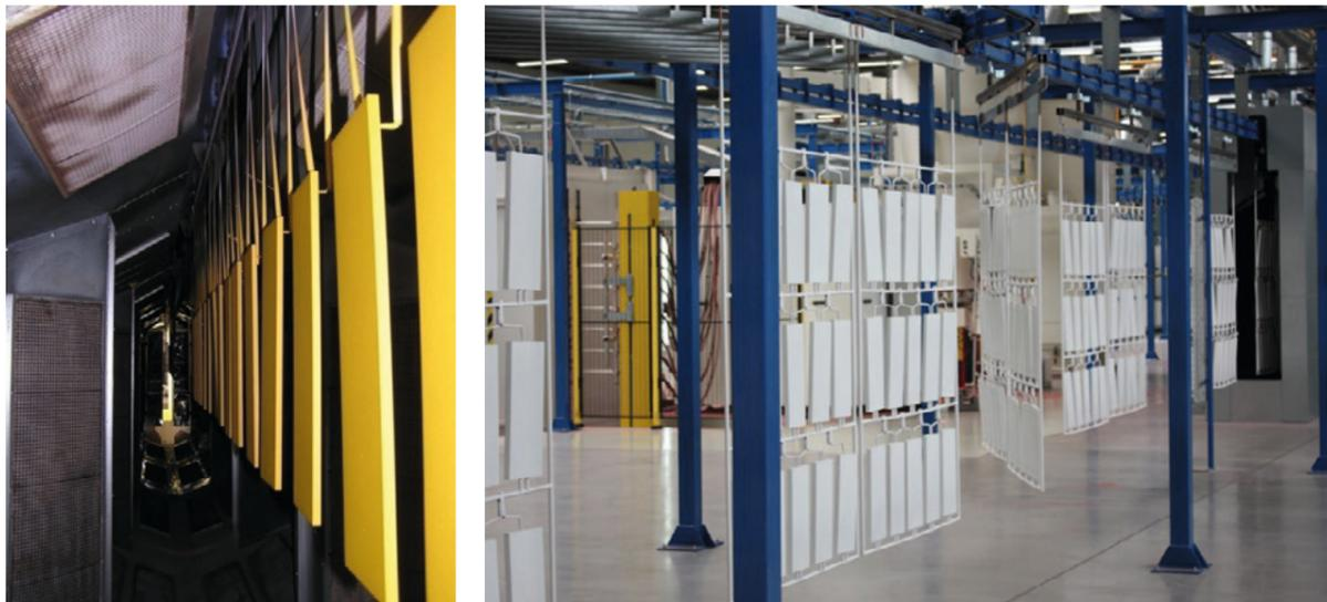
Gelieren und Aushärten durch Infrarotstrahlung
