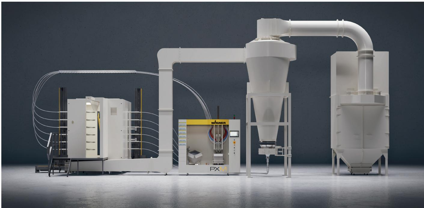
Con la E-Line di WAGNER è possibile rivestire in modo altamente efficiente i pezzi dei più svariati settori industriali con dimensioni fino a 2.000 x 800 mm. Il sistema permette cambi colore rapidi, un'eccellente qualità del rivestimento e un'elevata affidabilità del processo.
