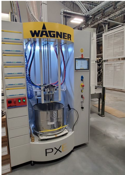
Kompaktes PXE Pulverzentrum für die effiziente Pulverförderung aus dem Fluidbehälter oder Pulverkarton
