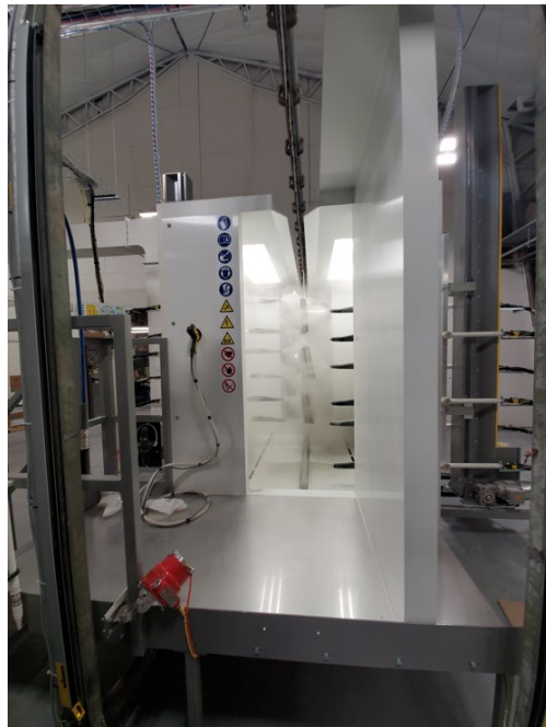
Automatische Beschichtung von Metallgehäusen für Luftauslässe und Heizregister
