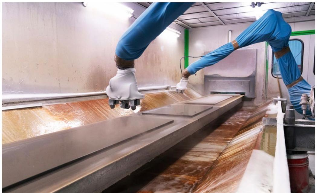
Durch den Einsatz von Hochdruck-Doppelmembranpumpen hat sich auch das Sprühbild der automatischen Lackapplikation bei der Neelsen GmbH verbessert.
