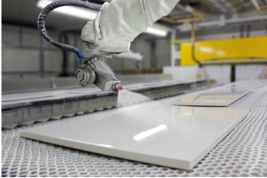
Automatische Nasslackapplikation für Holzwerkstücke
