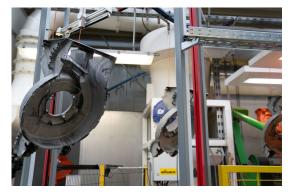
Mittels eines Laserscans werden die Werkstückkonturen vor der Pulverbeschichtung erfasst und die Pistolenabstände in der Kabine durch die automatische Lücken-, Höhen- und Tiefensteuerung entsprechend optimiert.
