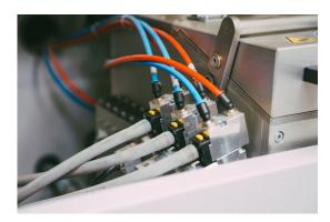
Die Injektortechnik von WAGNER ermöglicht eine luftarme Pulverförderung mit einer hohen Beschichtungseffizienz.
